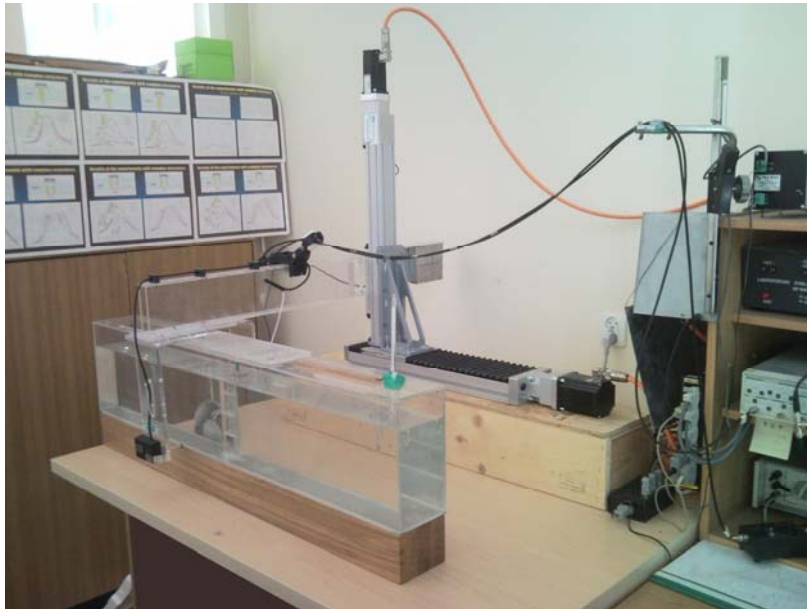
Rys. 9. Widok systemu pomiarowego MIT oraz badanego zbiornika wypełnionego wodą destylowaną z wtrąceniem z pleksi
