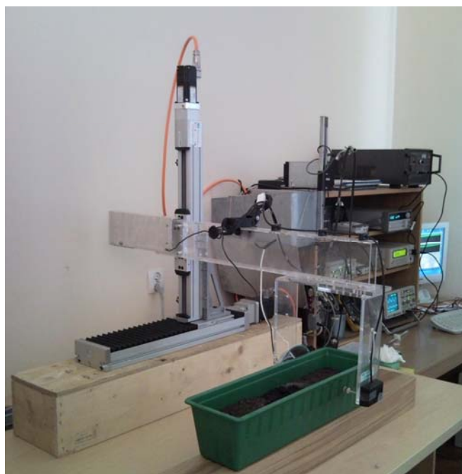
Rys. 1. Widok systemu pomiarowego MIT oraz badanego zbiornika wypełnionego wilgotną glebą
