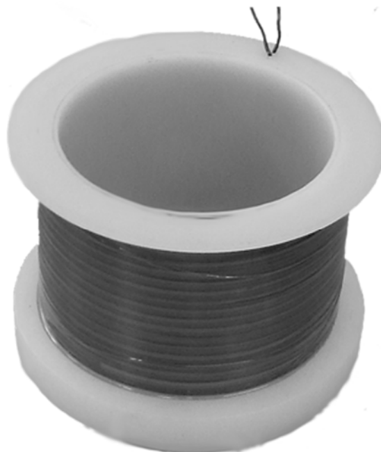
Rys. 2. Ogranicznik prądu z uzwojeniem wtórnym wykonanym z taśmy nadprzewodnikowej pierwszej generacji – AMSC High Strength Wire – o prądzie krytycznym I_c = 118 \text{ A}
