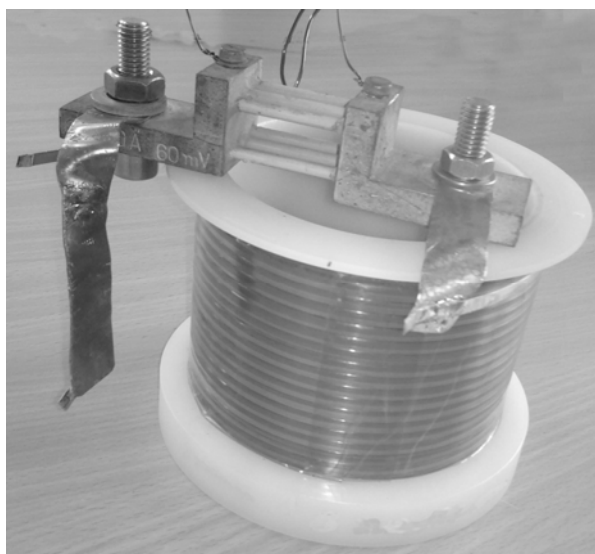
Rys. 4. Ogranicznik z zamontowanym bocznikiem
