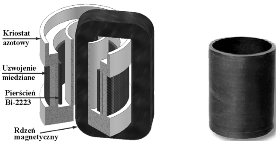
Rys. 1. Ogranicznik nadprzewodnikowy typu indukcyjnego z rdzeniem ferromagnetycznym. Po prawej stronie cylinder nadprzewodnikowy z materiału Bi-2223 o prądzie krytycznym I_c = 625 A
