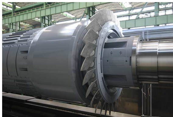
Rys. 1. Wirnik turbogeneratorskiego TWW-320-2Y3 z nowymi wentylatorami
