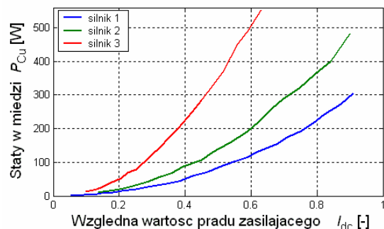
Rys.11. Charakterystyka strat w uzwojeniach \Delta P_{cu} w funkcji wartości prądu zasilającego I_{dc}
