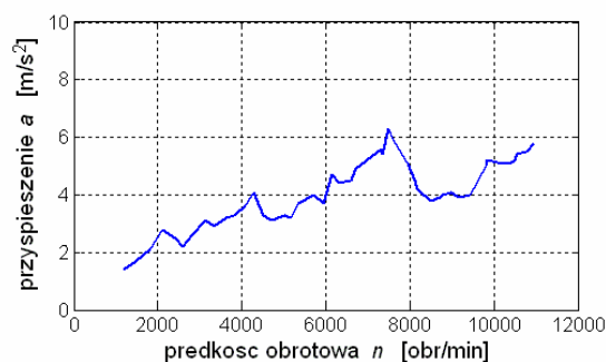
Rys.10. Zależność wartości skutecznej przyspieszenia w funkcji prędkości obrotowej dla silnika z wymienioną tarczą łożyskową
