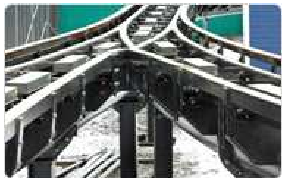
Rys. 4. Stojan silnika liniowego w pojeździe Vectus
