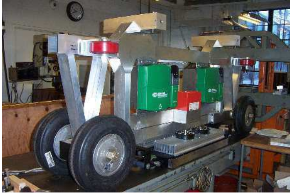
Rys.5. Podwozie pojazdu SkyWeb Express
