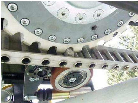
Rys.2. Rozwiązanie napędu w pojeździe typu Coaster
