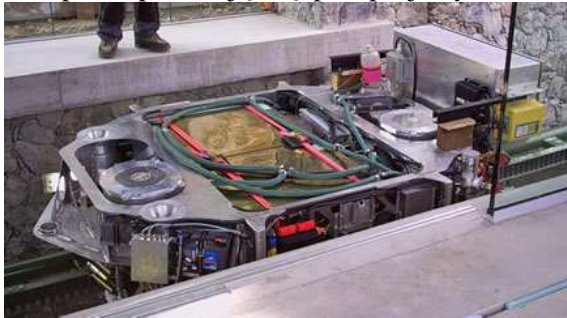
Rys.1. Podwozie pojazdu Coaster
