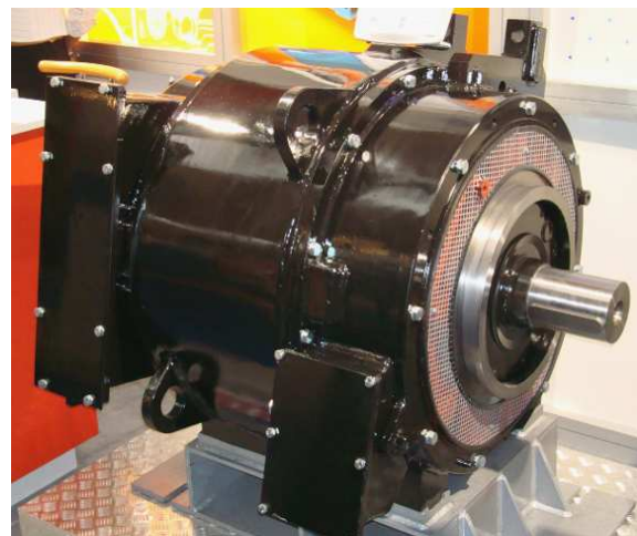
Rys.3. Silnik indukcyjny STx 500-4A, 830 kW do napędu lokomotywy
