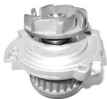
Rys. 2. Tradycyjna pompa cieczy chłodzącej wymontowana z silnika 178 B5.000
