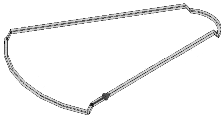
Rys. 5. Model pojedynczej cewki wraz z przyporządkowanym „coil terminal”
