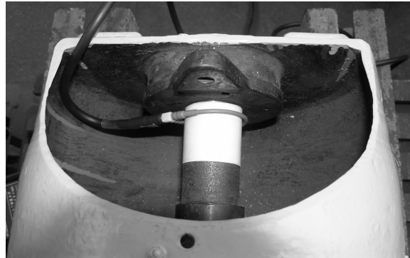
Rys. 5. Sposób zamocowania cewki Rogowskiego do pomiaru prądu łożyskowego
