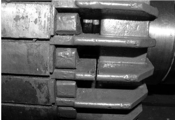
Rys. 7. Wirnik z odciętym prętem silnika typu dSKgw 315L-4 o mocy 300 kW
