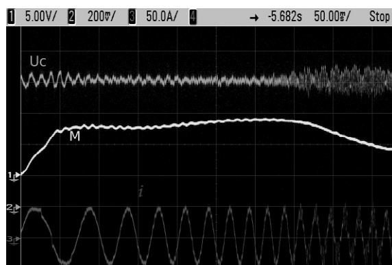
Rys. 4. Przebiegi przejściowe w układzie sterowania rzeczywistym falownikowym układem napędowym ze słabo tłumionym filtrem obwodu wejściowego a) bez kompensacji oscylacji, b) z kompensacją oscylacji i pomiarem napięcia sieci trakcyjnej
