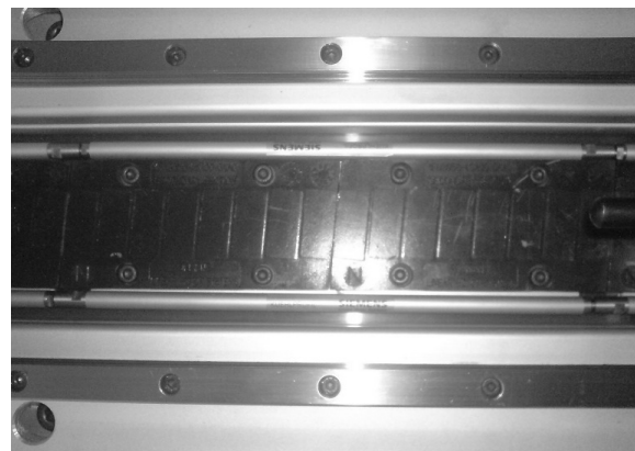
Rys. 2. Szyna robocza z magnesami trwałymi w badanym silniku synchronicznym liniowym
