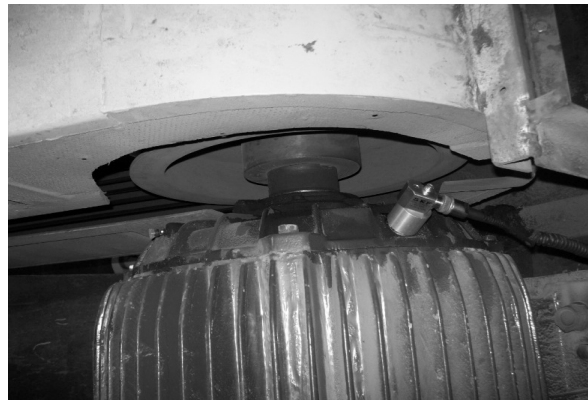
Rys. 4. Przykładowe usytuowanie czujnika drgań podczas diagnostyki łożysk tocznych.
