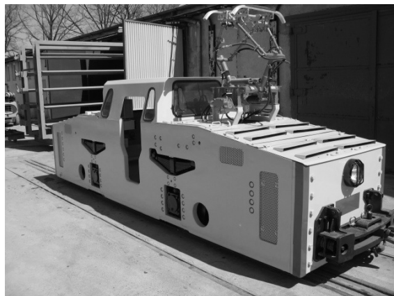
Rys. 3. Lokomotywa górnicza Ld-31 EM z silnikiem PMSM produkcji Komel, [3]
