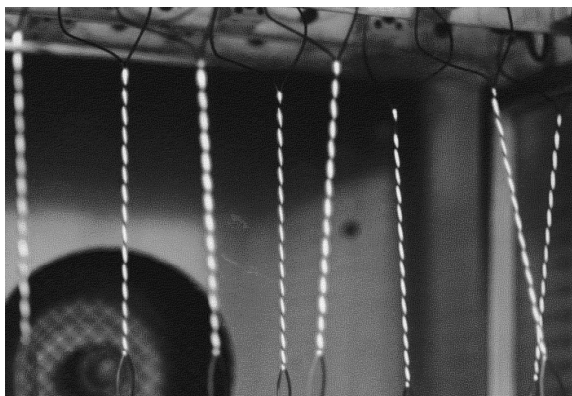
Rys. 4. Wyładowania niepełne na wiązce drutów. (twisted pairs)
