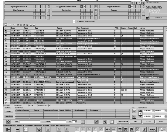
Rys. 4. Tabela alarmów generowana przez system CEMAT
