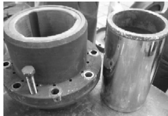
Rys. 6. Uszkodzone łożysko poprzeczne i tuleja silnika pompy 3NK2
