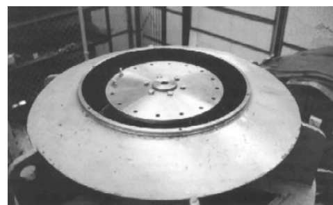
Rys. 22. Tarcza korekcyjna do doważenia, celowo zamontowana na wirniku silnika
