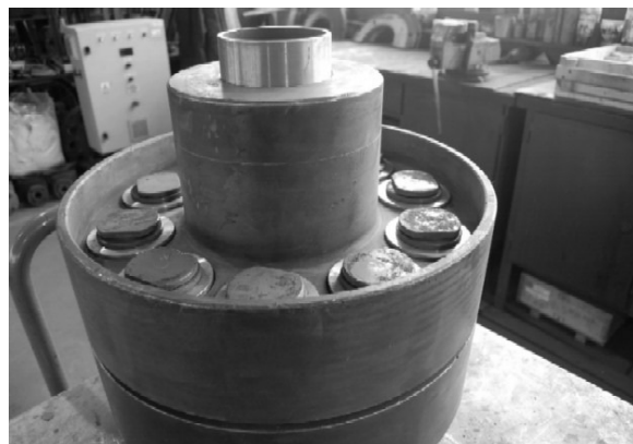
Rys. 15. Sprzęgło zespołu wentylatora młynowego z wkładkami pomiarowymi
