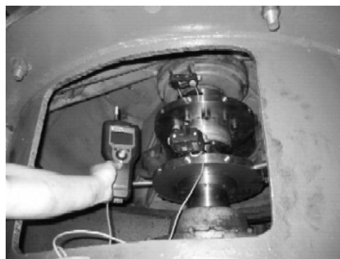
Rys. 21. Laserowe osiowanie wałów napędu i pompy
