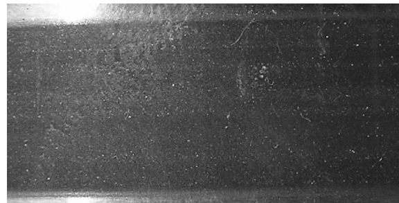
Rys. 18. Widoczne liczne małe wżery na powierzchni wewnętrznej pierścienia zewnętrznego
