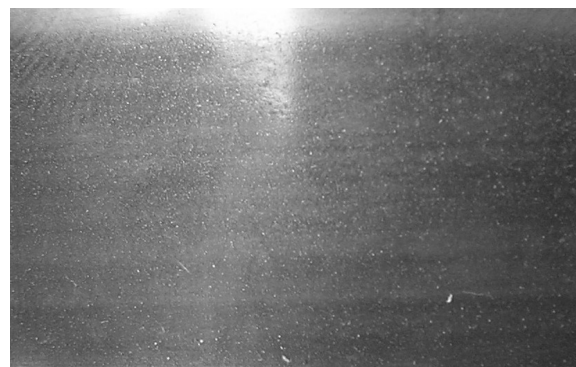
Rys. 19. Widoczne liczne małe wżery na powierzchni zewnętrznej pierścienia wewnętrznego
