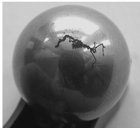
Rys. 12. Widoczne zygzakowate przypalenia na powierzchni kulki
