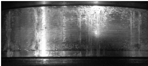
Rys. 7. Uszkodzenie czopa wału spowodowane przepływem prądu przez łożysko
