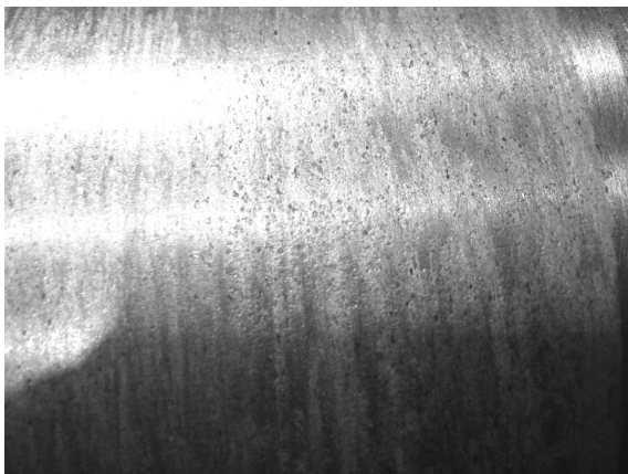
Rys. 20. Widoczne elektrowżery na czopie wału
