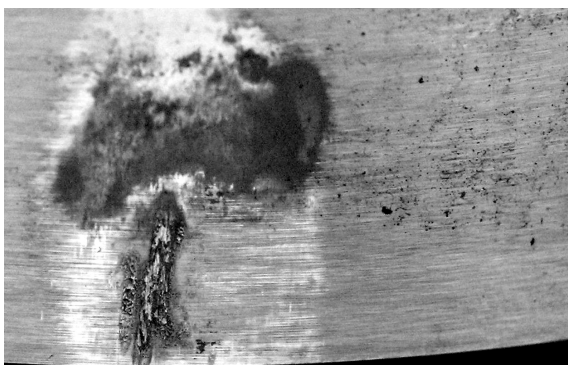
Rys. 9. Widoczny krater i małe wżery na powierzchni wewnętrznej pierścienia wewnętrznego
