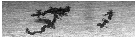
Rys. 7. Uszkodzenie czopa wału spowodowane przepływem prądu przez łożysko
