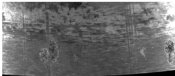
Rys. 4. Nieregularne wżery na bieżni wewnętrznej pierścienia zewnętrznego oraz dodatkowo widoczne regularne prążki
