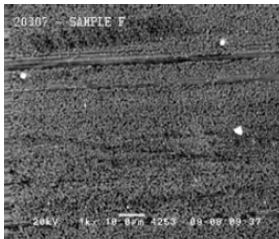
Rys. 3. Wżery jako wczesne stadium uszkodzeń
