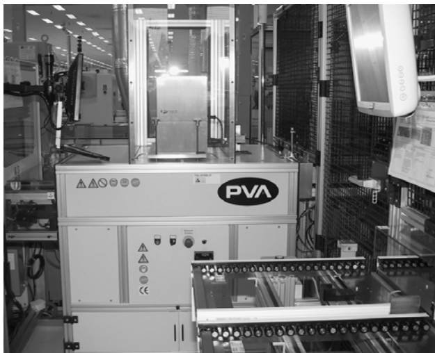
Rys. 1. Widok maszyny do utwardzania za pomocą promieniowania UV żelu ochronnego (fot. autor)
