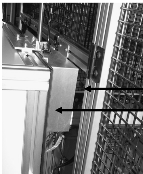
Rys. 2. Widok fragmentu maszyny z zainstalowaną dodatkową osłoną (fot. autor)
