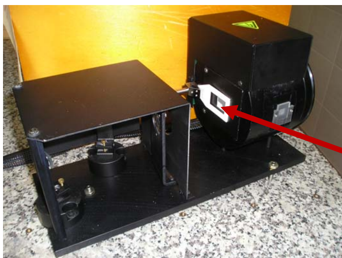
Rys. 3. Miejsce umieszczenia próbki w otworze pomiarowym kuli całkującej
