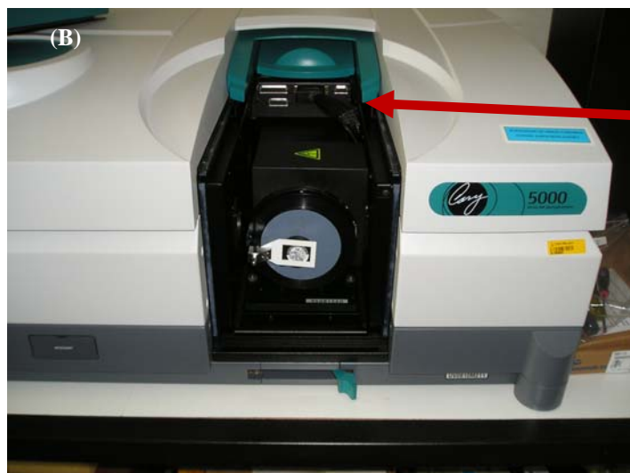
Rys. 2. Umieszczenie próbki materiału włókienniczego w komorze pomiarowej spektrofotometru; (A) – dobór geometrii pomiarowej i umieszczenie wzorca w kuli całkującej; (B) – kula całkująca w komorze pomiarowej spektrofotometru
