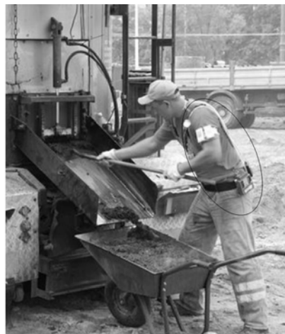
Rys. 2. Usytuowanie próbników na pracowniku
