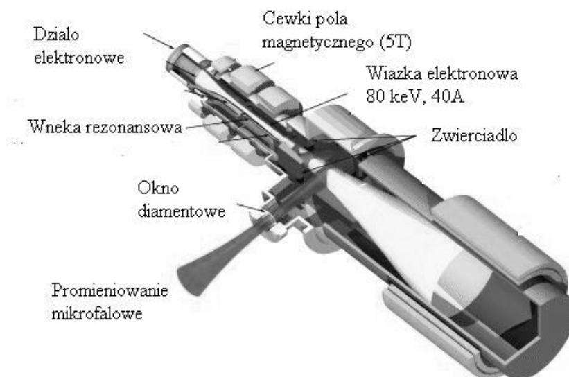
Rys. 3. Widok układu żyrotronowego emitującego promieniowanie mikrofalowe o mocy sięgającej od kilowatów do 2 Megawatów
