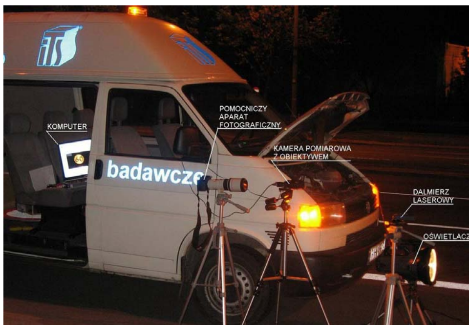
Fot. 1. Aparatura podczas pomiarów znaków na drodze
