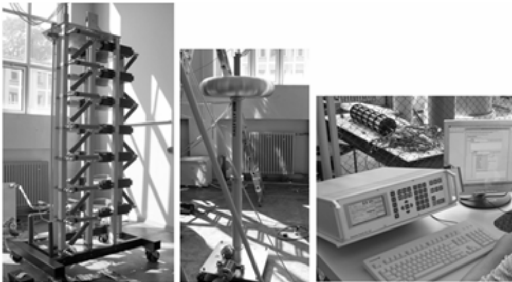
Rys. 5. Generator Napięć Udarowych HAEFELY® 700 kV, 35 kJ [2]
