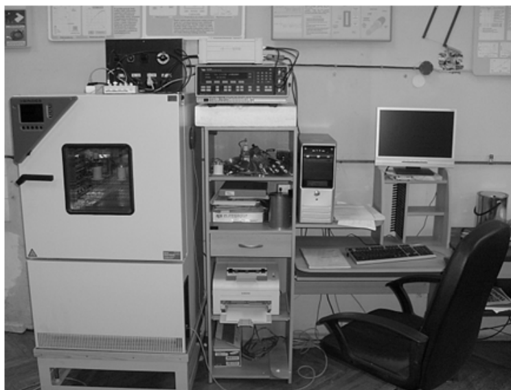
Rys. 10. Układ wykorzystany do pomiarów prądu TSD
