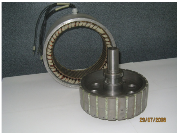
Rys. 1. Stojan i wirnik prądnicy GM 180M-24
