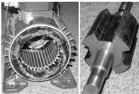
Rys. 2. Stojan i wirnik silnika reluktancyjnego
