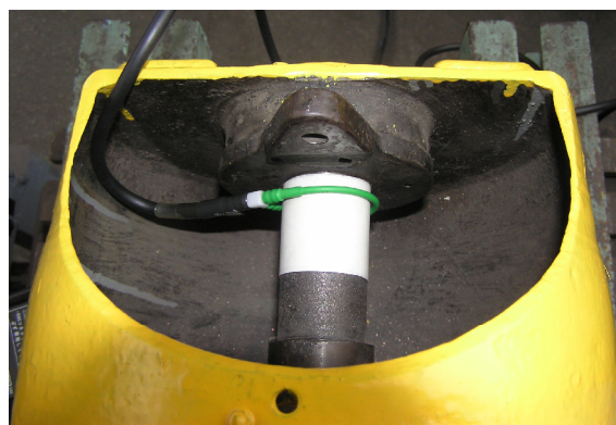
Rys. 4. Sposób zamocowania cewki Rogowskiego do pomiaru prądu łożyskowego
