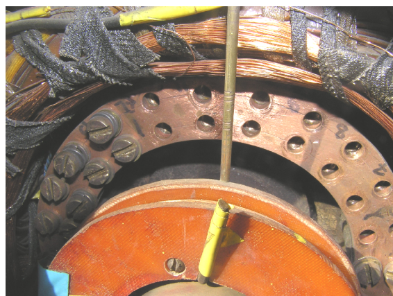
Rys. 2. Widok pierścienia zwierającego z odkręcanymi prętami
