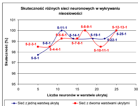
Rys. 7. Porównanie skuteczności neuronowych detektorów niewyosiowania dla różnych struktur sieci (uczenie i testowanie sygnałem drganiowym i prądowym)
