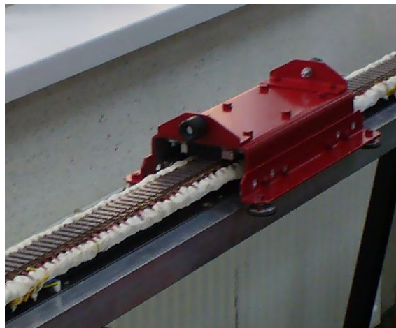
Rys. 5. Model liniowego silnika indukcyjnego
