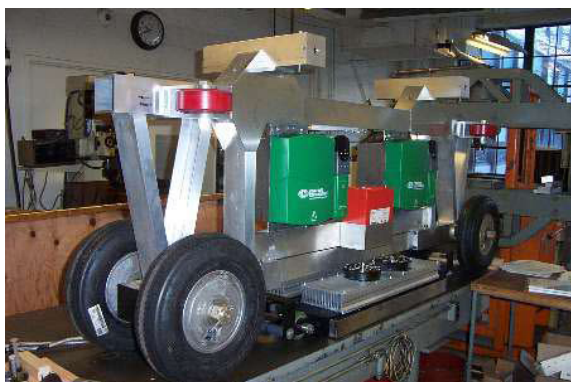
Rys. 8. Podwozie pojazdu Skyweb Express
