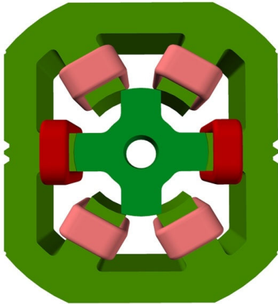
Rys. 2. Widok geometrii proponowanego silnika SRM
