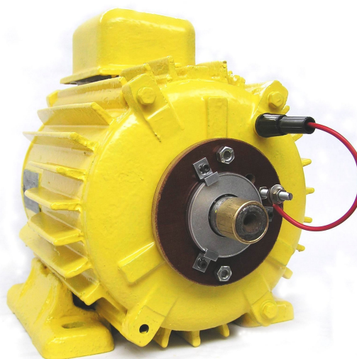
Rys. 19. Silnik indukcyjny typu SZJe 24a o mocy 1,5 kW z zamontowanym pierścieniem
