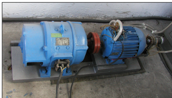
Rys. 2. Stanowisko badawcze silnika 3 kW
