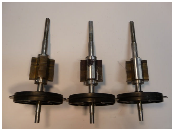
Rys. 8. Widok wirników silnika SRM będących obiektami badań laboratoryjnych
