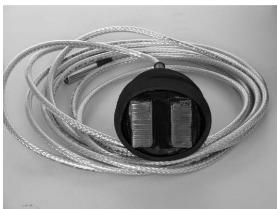
Rys. 15. Czujnik indukcyjny do badania stojanów
