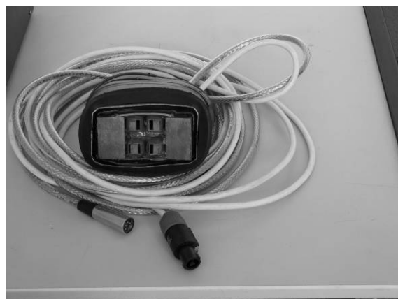
Rys. 16. Wzbudnik wraz z czujnikiem indukcyjnym do badania wirników
