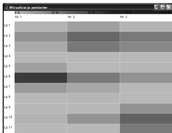
Rys. 12. Wyniki pomiarów wskaźnika k_z w postaci mapy uszkodzeń
