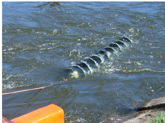
Rys. 6. Model turbiny ślimakowej w trakcie prób na rzece Wolbórze
