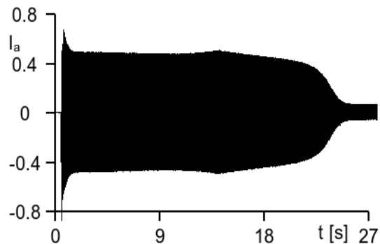
Rys. 21. Przebieg prądu rozruchowego jednej fazy stojana z zawartością sygnału niediagnostycznego
