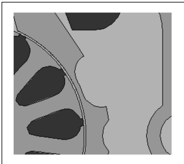
Rys. 5. Przekrój poprzeczny silnika SFZ, model 2MES - bocznik z wycięciem zewnętrznym
