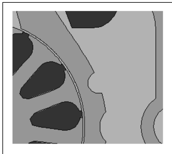
Rys. 4. Przekrój poprzeczny silnika SFZ, model 1NMES - bocznik produkcyjny
