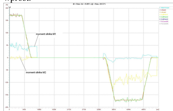
Rys. 5. Układ napędowy podpory mostu jazda na wprost w obu kierunkach
