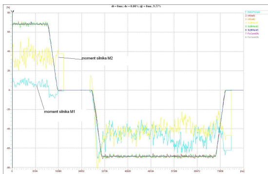
Rys. 6. Układ napędowy podpory mostu jazda na wprost w obu kierunkach
