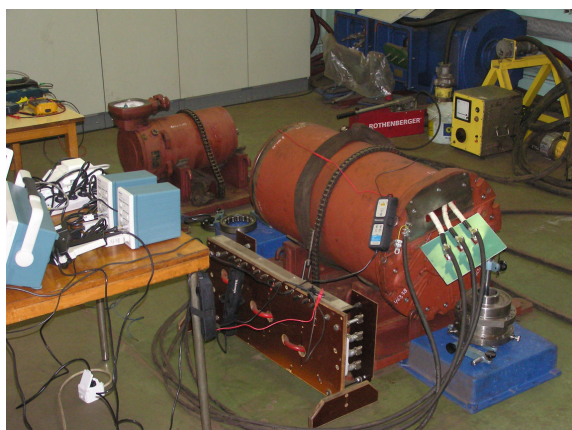
Rys. 3. Stanowisko pomiarowe z silnikiem typu dSKgw 315L-4, 300 kW, 1000 V
