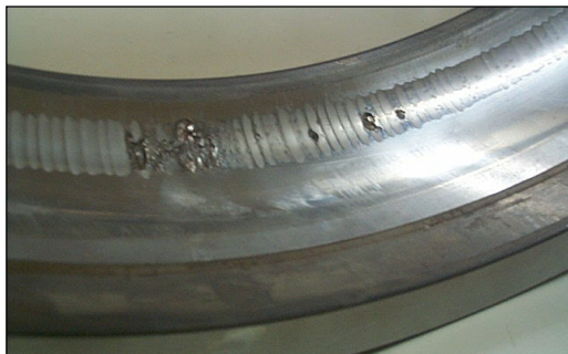
Rys. 4. Uszkodzenie bieżni łożyska wywołane przepływem prądu łożyskowego
