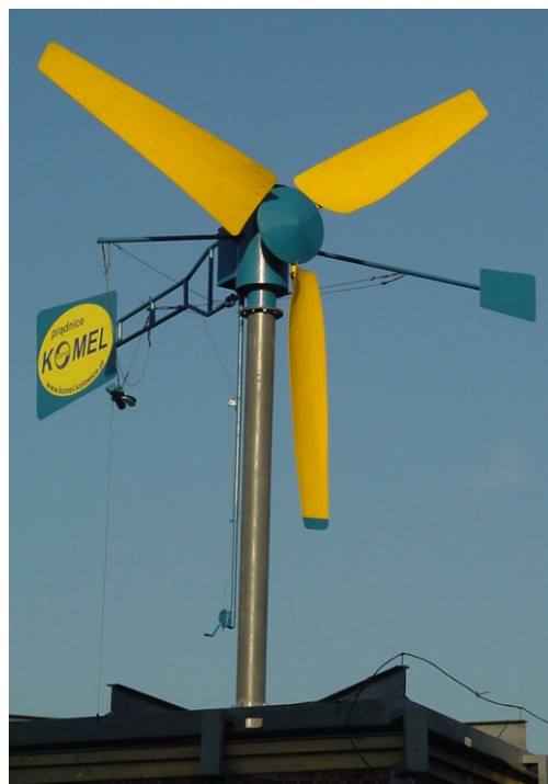
Rys. 22. Przykładowy sposób wykorzystania prądnic synchronicznych z magnesami trwałymi
