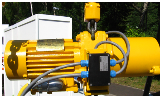
Rys. 13. Silnik górniczy samohamowny o mocy 1.1 kW typu SGKg80-4Hp
