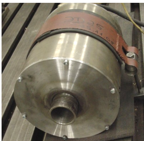
Rys. 15. Silnik 1,1 kW z wałem drążonym
