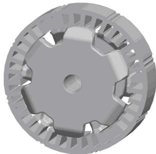
Rys. 1. Obwód magnetyczny alternatora
