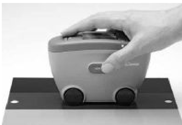
Rys. 12. Wave-scan DUAL do pomiarów struktury na powłokach o wysokim i średnim połysku.
