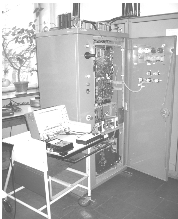
Rys. 3. Układ badawczy falownika napięcia o mocy 100 kW
