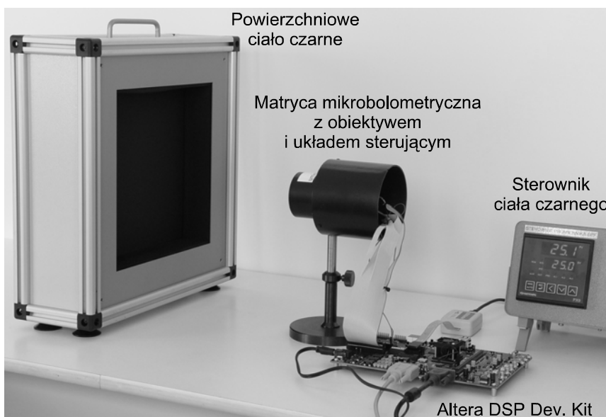
Rys. 4. Stanowisko do badania skuteczności algorytmu NUC
