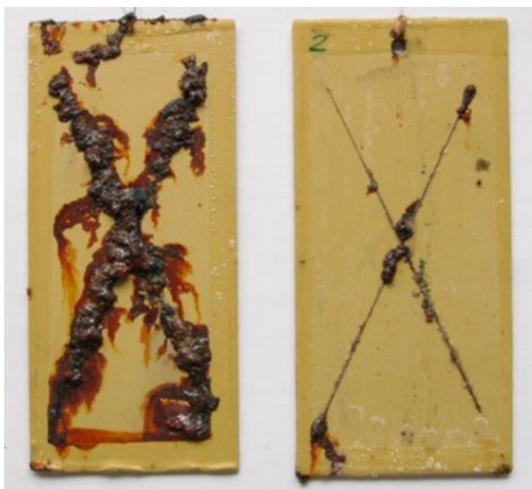
Rys. 12.11. Powłoka farby epoksydowej wyjściowej (z lewej) i z dodatkiem 2% mas. pigmentu 3 (z prawej) po 56 cyklach dobowych narażeń w komorze z testem specjalnym [320]
