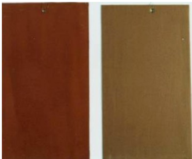
Rys. 12.4. Powłoka poliwinylowej farby wyjściowej (z lewej) i powłoka farby poliwinylowej z dodatkiem 2% pigmentu 3 [318]
