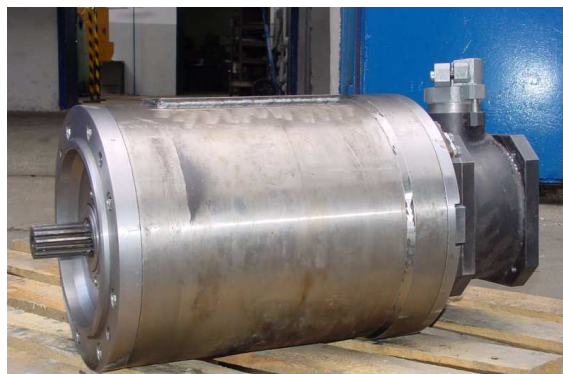
Rys. 2. Silnik górniczy o mocy 85kW
