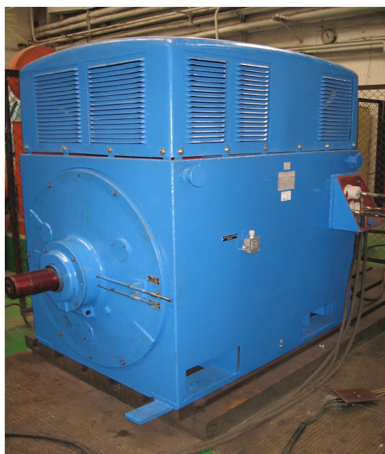
Rys. 1. Silnik starszej generacji napędu młyna cementu (po remoncie) DSE 1318
