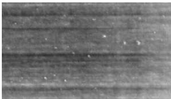
Rys. 9. Widoczne liczne małe wżery i smugi obwodowe w łożysku waleczkowym na powierzchni waleczków
