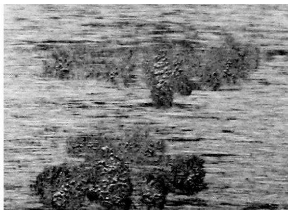
Rys. 2. Widoczny krater na powierzchni zewnętrznej pierścienia zewnętrznego
