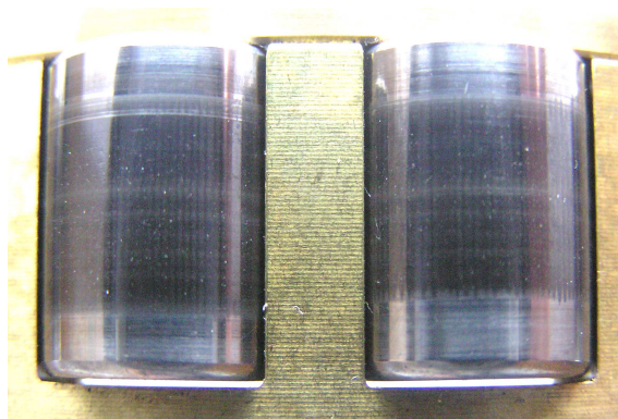
Rys. 10. Widoczne liczne małe wżery i prążki na powierzchni waleczków
